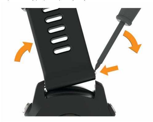
NOTA: asegúrate de que la correa está fija. El perno debe quedar alineado con los orificios del dispositivo.
