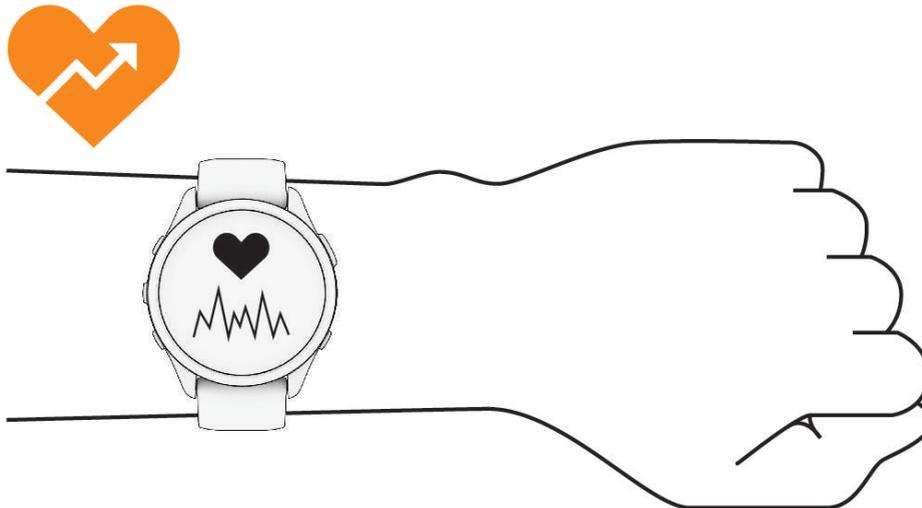
**NOTA:** el sensor óptico está ubicado en la parte trasera del reloj.
