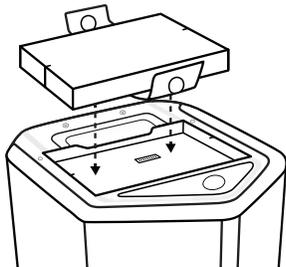
5. Coloque en su posición original la placa inferior y asegúrela con los 2 tornillos que sacó en el Paso 2.
