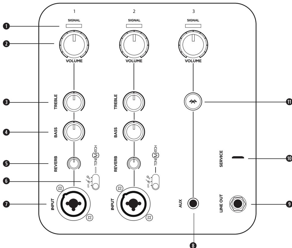
Utilice las entradas de canal 1 y 2 para los micrófonos e instrumentos musicales. El procesamiento de señal ToneMatch® integrado permite que obtenga el mejor sonido posible de los micrófonos y los instrumentos. Utilice el canal 3 para la conectividad Bluetooth® y las entradas de nivel de línea.
